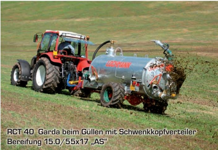
RCT 40 Garda beim Güllen mit Schwenkopfverteiler
